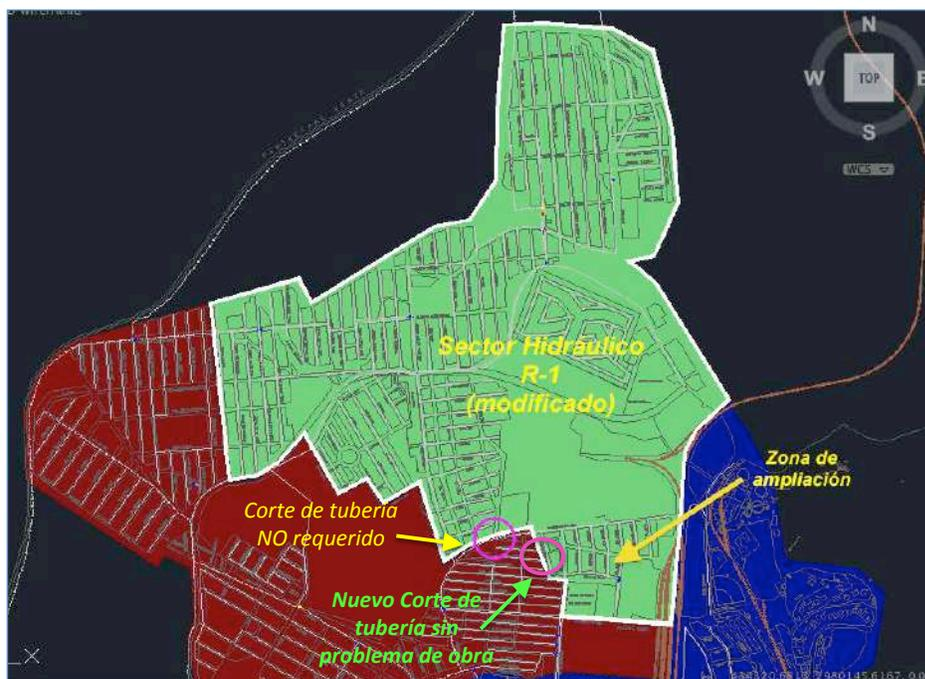
Figura 4-4. Plano del sector de proyecto ampliado en su diseño original, en la ciudad del ejemplo.
