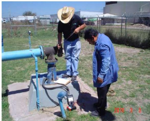
*Figura 5.3.b. Medición del nivel dinámico del agua en un pozo.*
