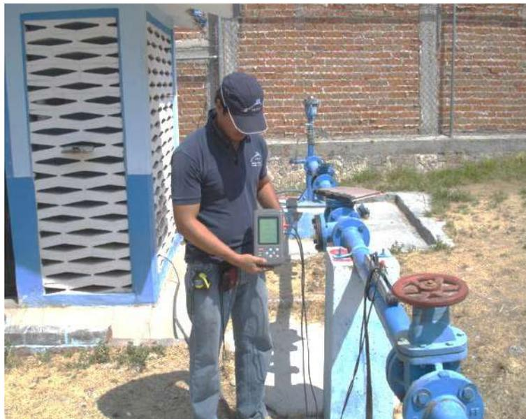
*Figura 2-33. Registro de volumen de agua suministrada con medidor portátil.*
