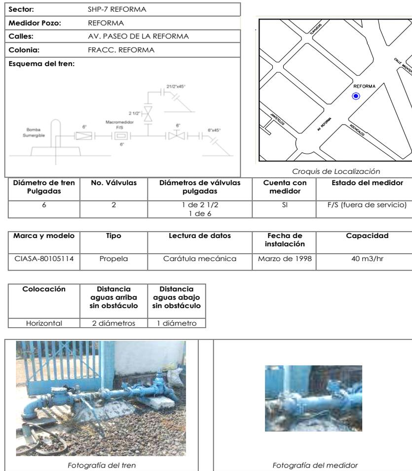
Figura 4-22. Ficha técnica de inspección de medidor en un pozo de suministro de agua potable a la red de distribución.
