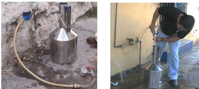
*Figura 2-40. Equipo para la prueba en campo con objeto de obtener los errores de exactitud en medidores instalados en tomas domiciliarias de usuarios.*
