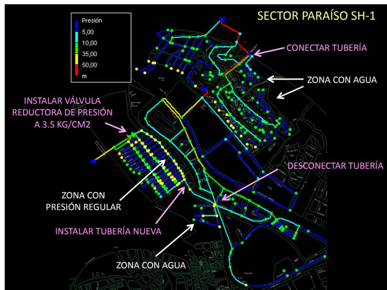
3.1.d. Resultados de presión y caudal con el modelo de la red secundaria de diseño en el sector SH-1 Con las adecuaciones en la red (conexión, desconexiones, instalación de válvulas reductoras de presión y tubería nueva), se regulan las presiones en toda la red del sector.
