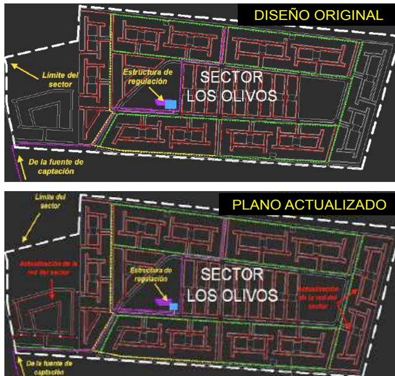
Figura 5-33. Ejemplo de actualización de plano, por la construcción de nuevos fraccionamientos en el sector de diseño original.
