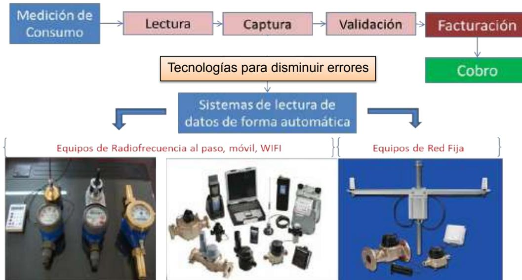
*Figura 5-24. Equipos comerciales de lectura remota y procesamiento de facturas de volumen en micromedidores de usuarios.*
