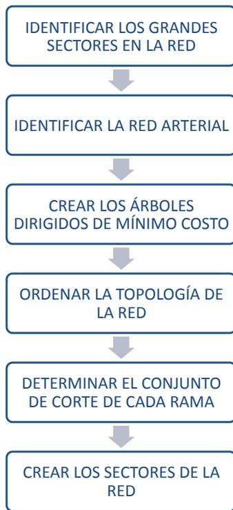
Figura A-6. Secuencia de pasos para llevar a cabo la sectorización de la red con el algoritmo de Vegas y Martínez.
