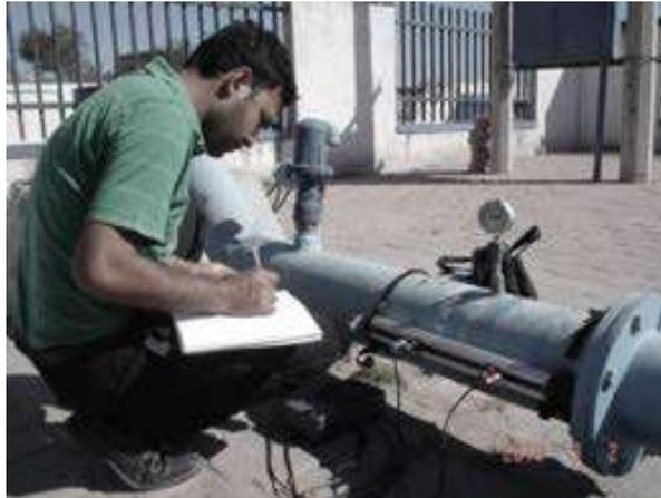
*Figura 5.3.a. Medición de caudal y presión en una tubería.*
