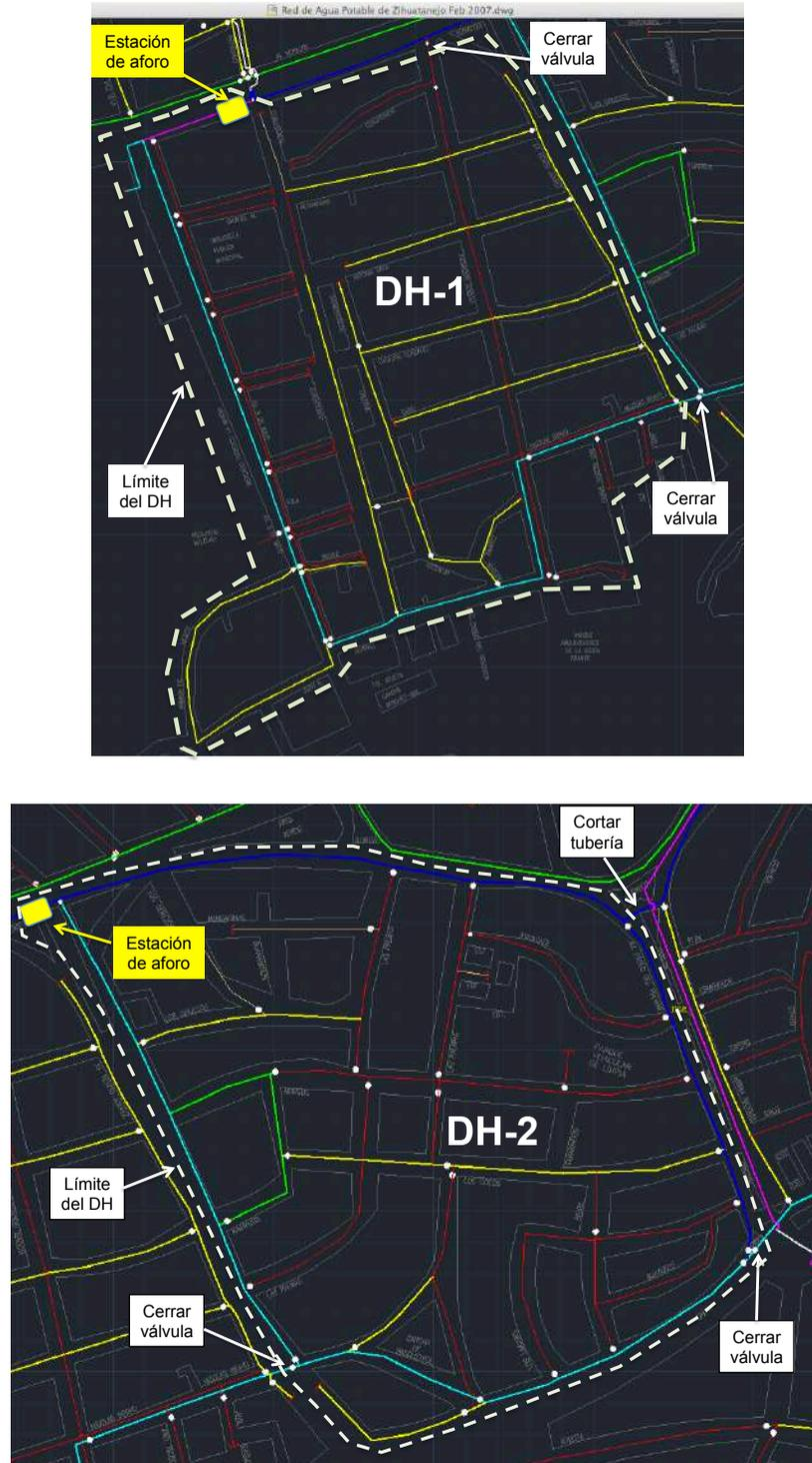
Figura 3-23. Detalles de los distritos DH-1 y DH-2 conformados en el modelo de simulación hidráulica.
