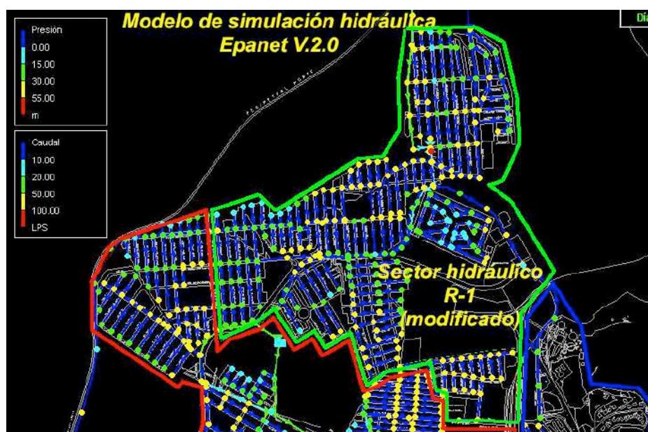
Figura 4-5. Resultados de caudal y presión en el modelo de simulación hidráulica del sector ampliado en su diseño original, de la ciudad del ejemplo.
