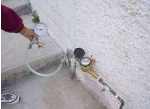
Figura 4-26. Manómetros fijo y portátil para medición de presión del agua en tuberías.
