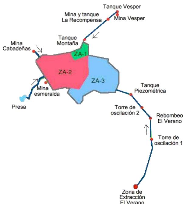
*Figura 2-75. Esquema de abastecimiento de agua potable y zonas de influencia de operación hidráulica en una ciudad.*
