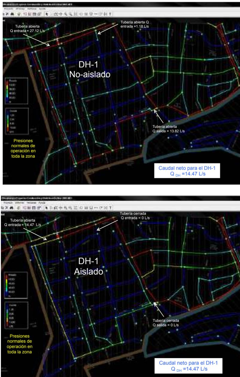
*Figura 3-24. Análisis hidráulico del DH-1, sin y con aislamiento físico, respectivamente.*
