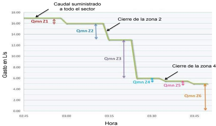
Figura 5-19. Registro de caudales durante la prueba de subdivisión nocturna de un sector del ejemplo.
