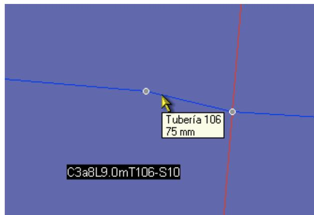
*Figura 3.27.b. Etiqueta: C3a8L9.0mT106-S10 Descripción: Conexión de 3" a 8" con longitud de 9.0m, Tubería No.106 del Sector hidráulico 10.*
