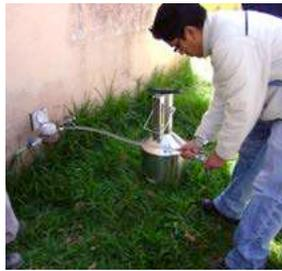
Equipo para prueba de exactitud en micromedidores
